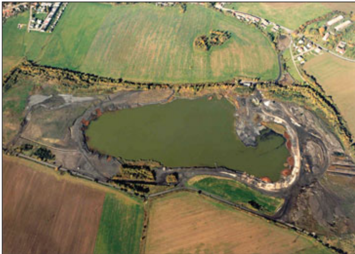
Olešník, 1998 a 2010. Kalojemy v Mydlovarech jsou jámy, které zde zůstaly po těžbě lignitu. Dosahují hloubky až 40 m. foto: Rekka
